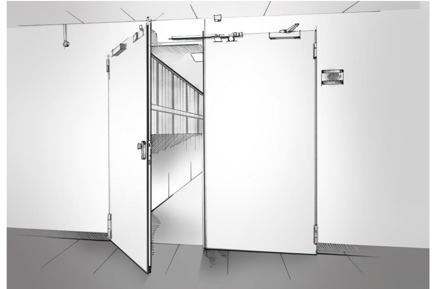
Beispielhafte Brandschutztür, die als Schleuse zwischen zwei Brandabschnitten dient.
